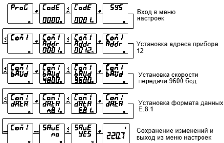
Рисунок 4.5 Настройка порта связи RS-485
